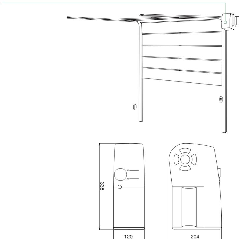
**NOTA** En caso de puertas seccionales superiores a 22 m<sup>2</sup> y de hasta 34 m<sup>2</sup> es necesario el uso del kit VISCH.
