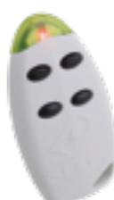
Trasmittitore radio a 4 canali su frequenza 433,92 MHz.
