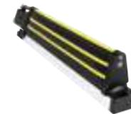
Bord sensible de sécurité à contact résistif 8,2 K $\Omega$ , conforme à la norme UNI EN 12978, monté sur profilé en aluminium. L=250 cm.
