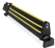
Bord sensible de sécurité à contact résistif 8,2 K $\Omega$ , conforme à la norme UNI EN 12978, monté sur profilé en aluminium. L = 150 cm.
