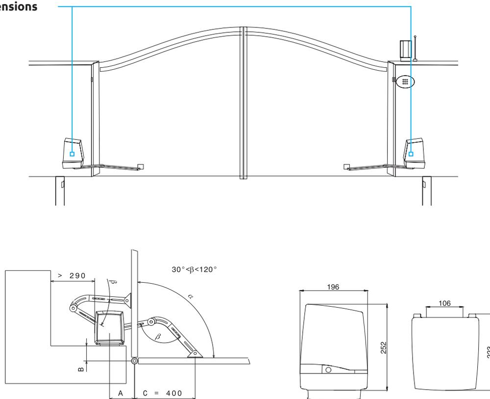
**NB.** Angle  $\beta$  à maintenir entre  $30^\circ/120^\circ$  pour obtenir un débloquage optimal, évaluer différemment l'utilisation du bras ARMAX
