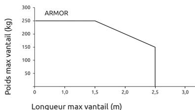
**NB.** Dans les zones soumises au vent ou si le portail présente des formes structurelles particulières, il est recommandé de réduire les limites d'utilisation et d'installer une serrure électrique. Évaluer l'utilisation d'ARMAX, bras articulé agrandi avec des vantaux à panneaux
