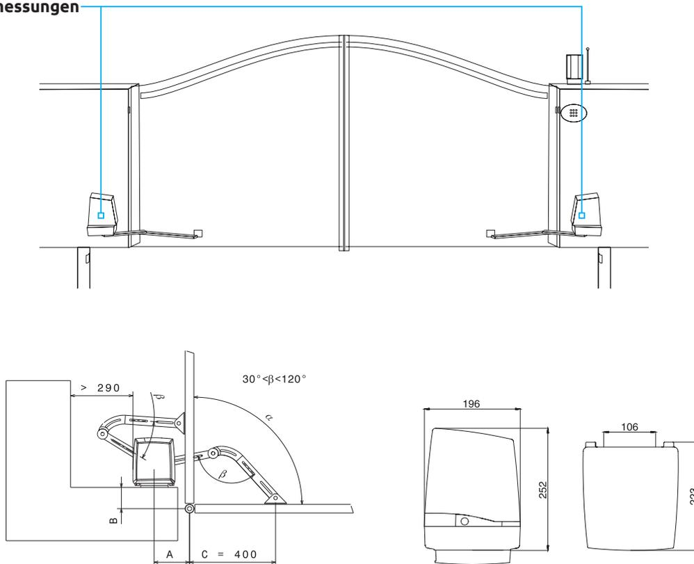
**Hinweis:** Für eine optimale Entriegelung muss der Winkel  $\beta$  zwischen  $30^\circ/120^\circ$  gehalten werden, anderenfalls sollte eventuell der Arm ARMAX verwendet werden.
